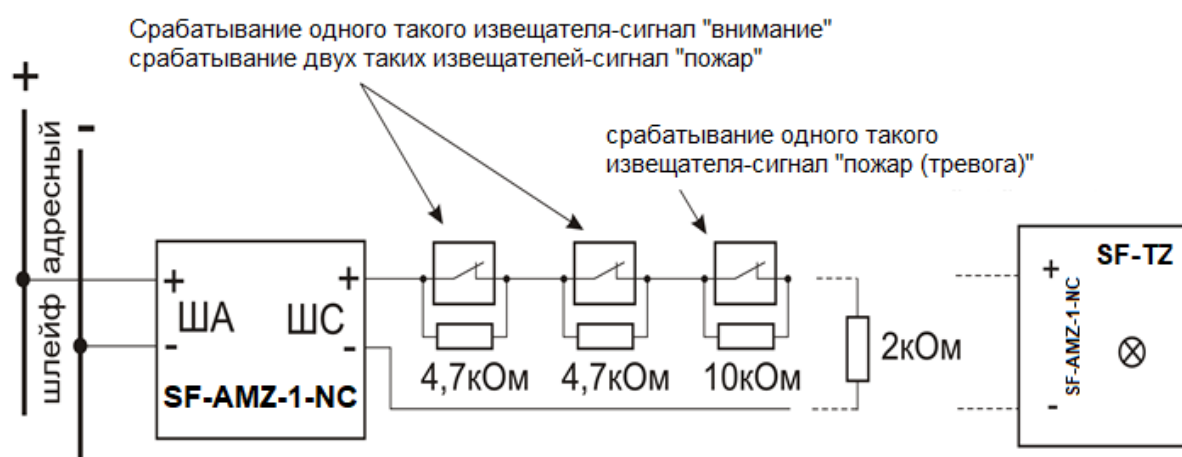
Схема подключения SF-AMZ-1-NC
