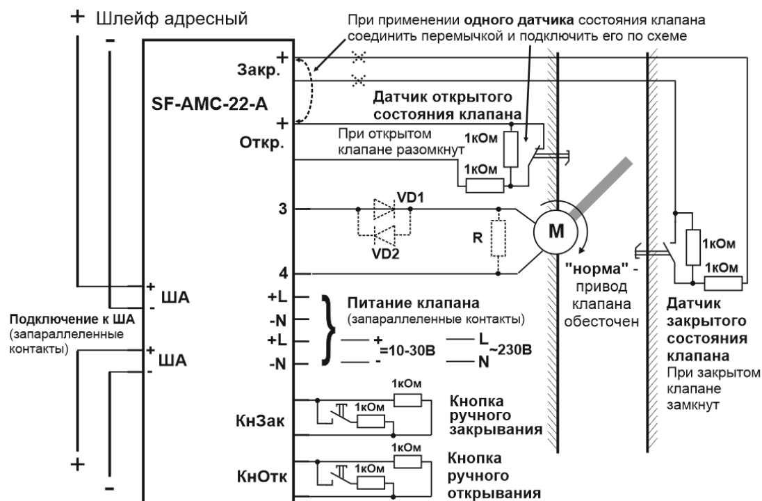
Схема подключения нормально выключенного привода с одним вводом
